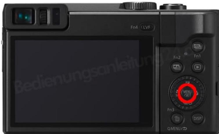
2. Wählt nun das **SETUP** aus (Schraubenschlüssel-Symbol).
