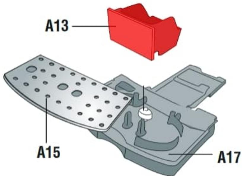
3. Auch die rote Kondenswasserschale kontrollieren und falls sie voll ist, entleeren.
