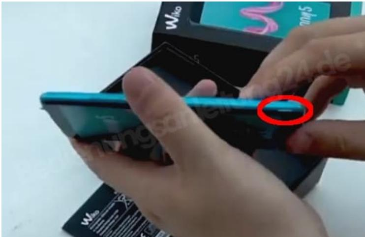
2. Es geht einfacher, wenn ihr das Handy umdreht. Nutzt nun die eingelassene Rille und greift mit einem Fingernagel hinein und hebt den Deckel etwas an. Greift nun mit weiteren Fingern nach, damit ihr den Deckel lösen könnt.
