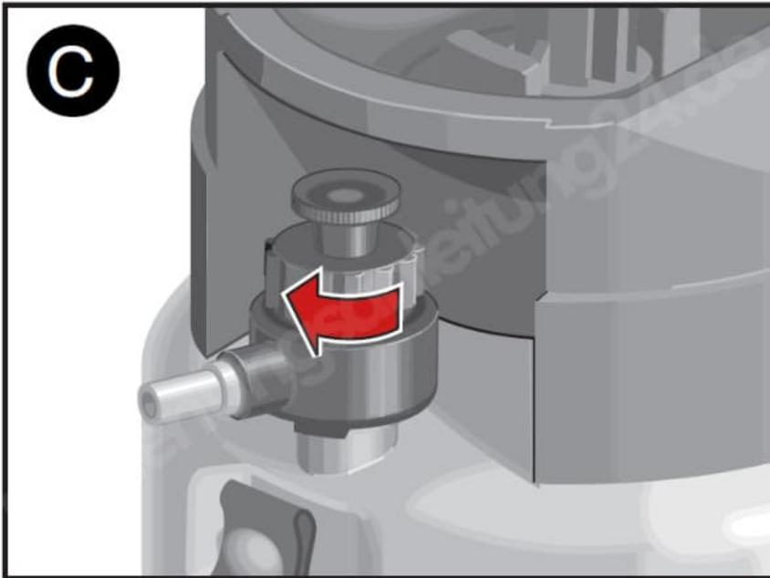
4. Ventil vom Druckluftschlauch (nicht im Lieferumfang enthalten) auf Druckluftanschluss (2) stecken und fixieren.
