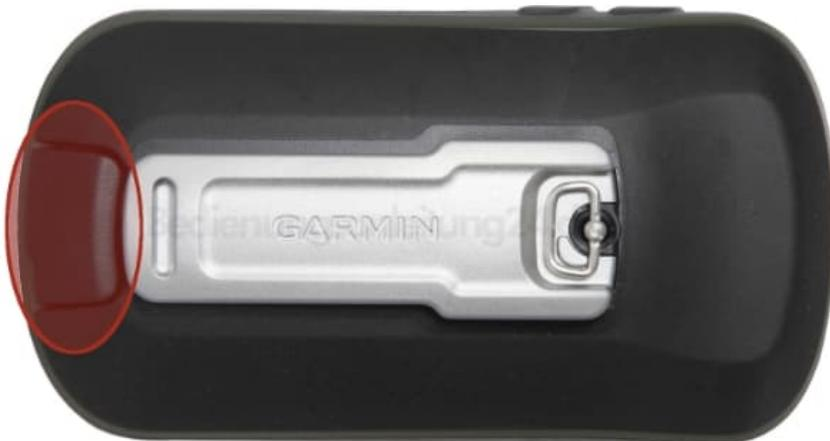
2. Hebe die Schutzkappe über dem Mini-USB-Anschluss an.
