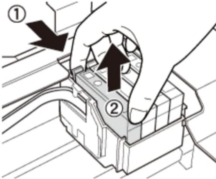
8. Setzen Sie die neue Tintenpatrone ein und drücken Sie sie fest herunter.
