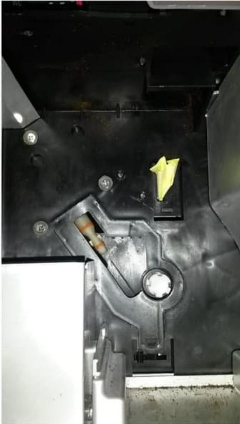
6. Schließe die Seitentür und schalte die Maschine ein und warte ca. 2 Sekunden, bis die Maschine zurückfährt. Sobald der Motor still ist, mache die Seitentür sofort auf.
