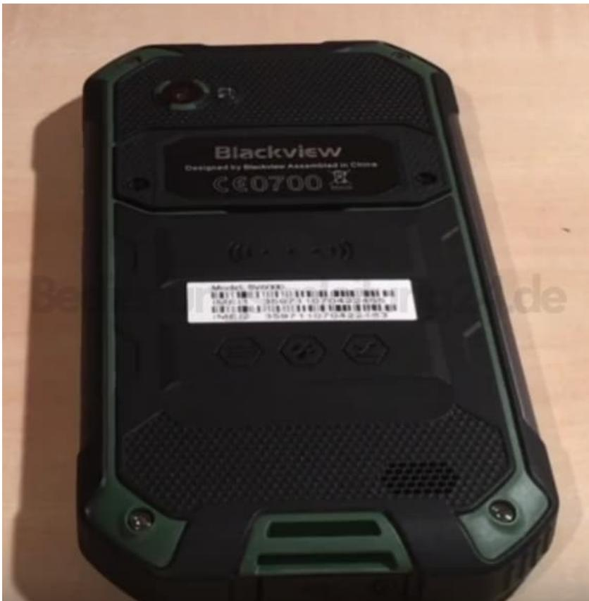
2. Löst mit einem Schraubendreher die zwei Schrauben links und rechts.
