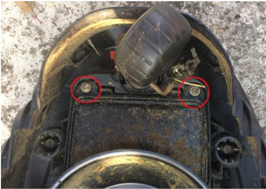
5. Löst diese beiden Schrauben und nehmt sie heraus.
