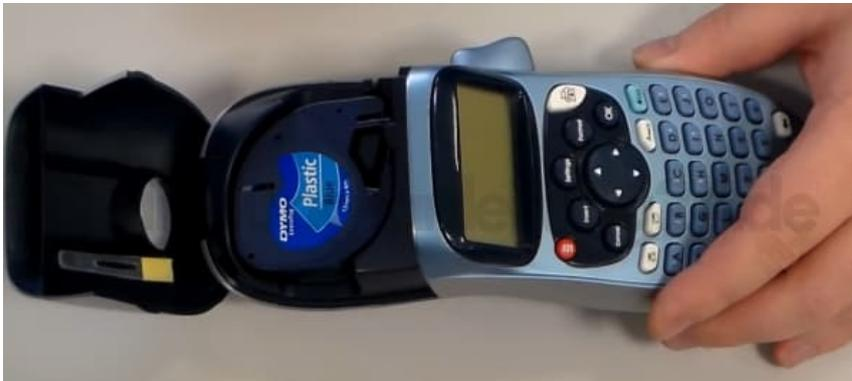
2. Nehmt die Schriftbandkassette aus dem Gerät.
