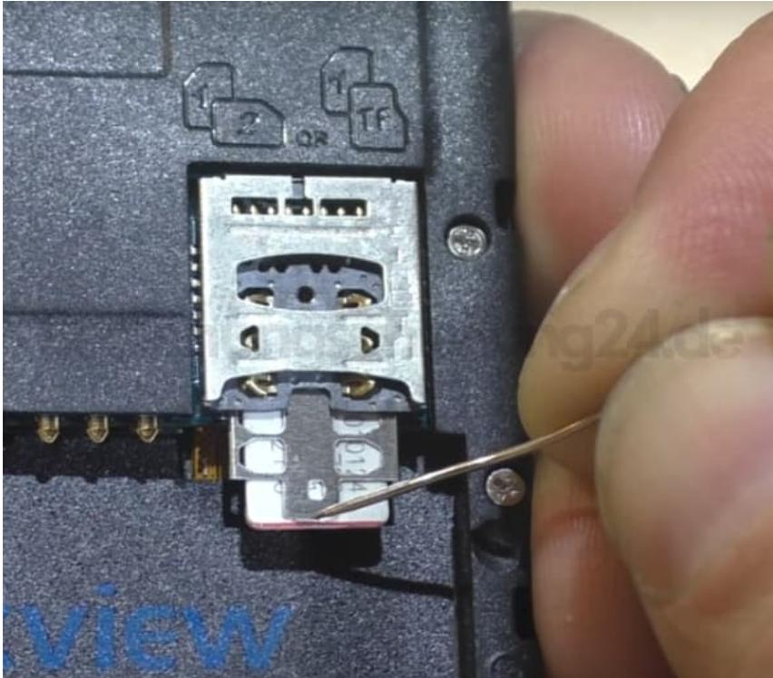
7. Schiebt nun SIM 2 **quer** in den Slot darüber. Seht euch die Grafik aus Schritt 5 notfalls noch einmal an.
