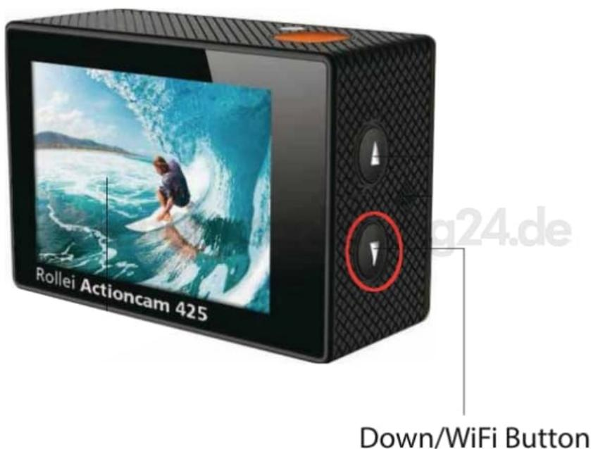
4. Verbinde dein Smartphone oder Tablet in den WiFi Einstellungen des Gerätes mit dem Netzwerk **Rollei AC425**.
