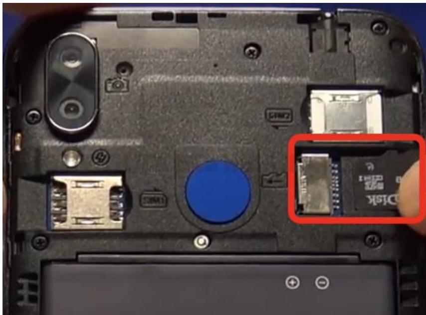
5. Falls ihr eine weitere SIM verwenden wollt, setzt ihr diese in den Slot SIM2 ein. Dieser befindet sich links. Hier zeigt die abgeschrägte Ecke der SIM nach rechts oben.
