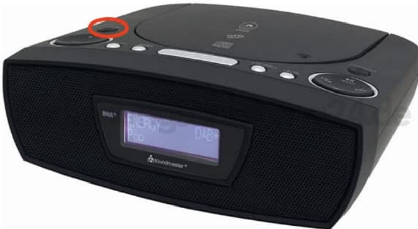
2. Drücken und halten Sie die **“INFO/?”** Taste, bis **“Press Select key to Reset”** angezeigt wird.
