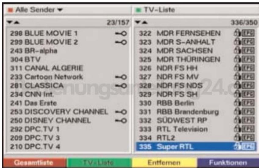
5. Durch Drücken der **roten Funktionstaste** wechselt die Markierung zur Gesamtliste. Diese ist nun aktiv. Durch nochmaliges Drücken der **roten Funktionstaste** erscheint ein Auswahlfenster. Sie haben hier die Möglichkeit, die Gesamtliste nach verschiedenen Auswahlkriterien (z.B. alle Sender, alle freien, alle neuen, alle gefundenen, alle englischen, usw.) sortiert oder nach Anbietern sortiert anzuzeigen.
