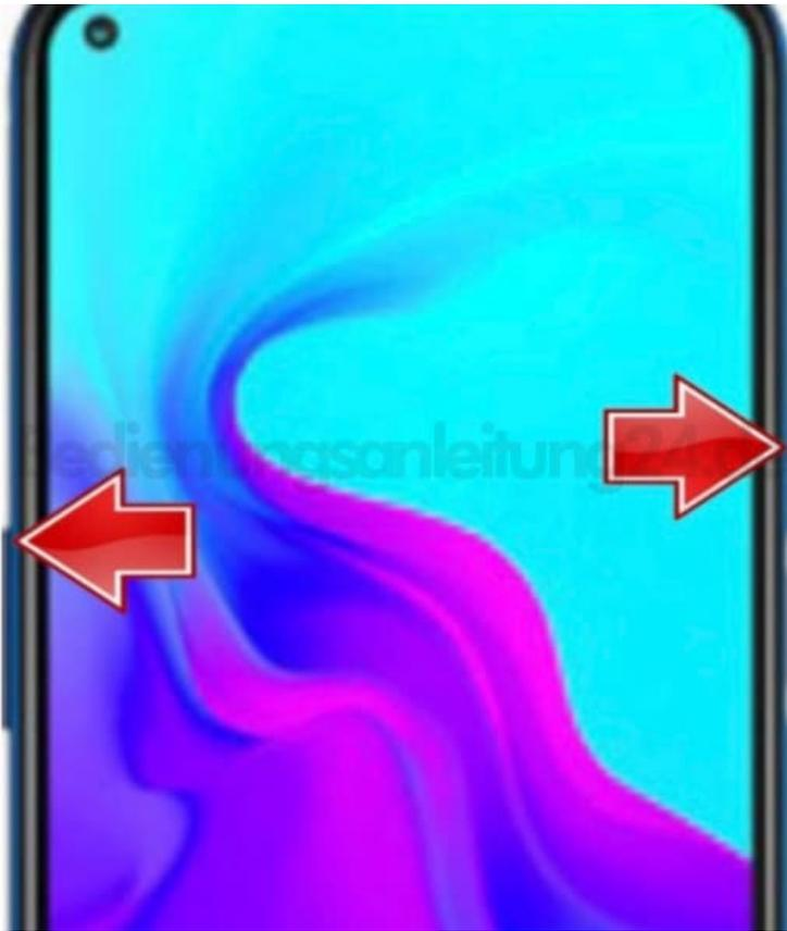
3. In diesem Modus wählst du mit der **Lautstärke-Lauter**-Taste die Position des Wiederherstellungsmodus **Recovery Mode** und bestätigst mit der **Lautstärke-Leiser**-Taste.
