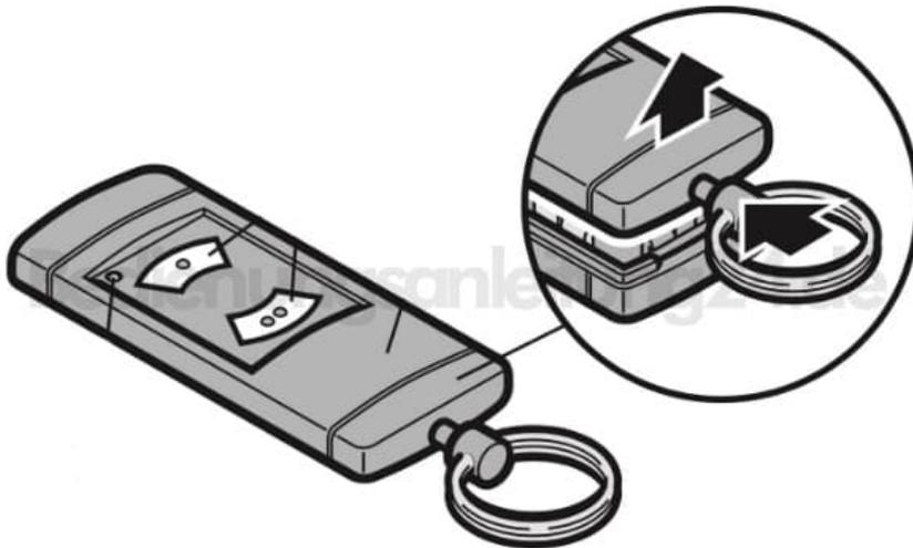
2. Entferne die alte Batterie und setze eine neue ein.
