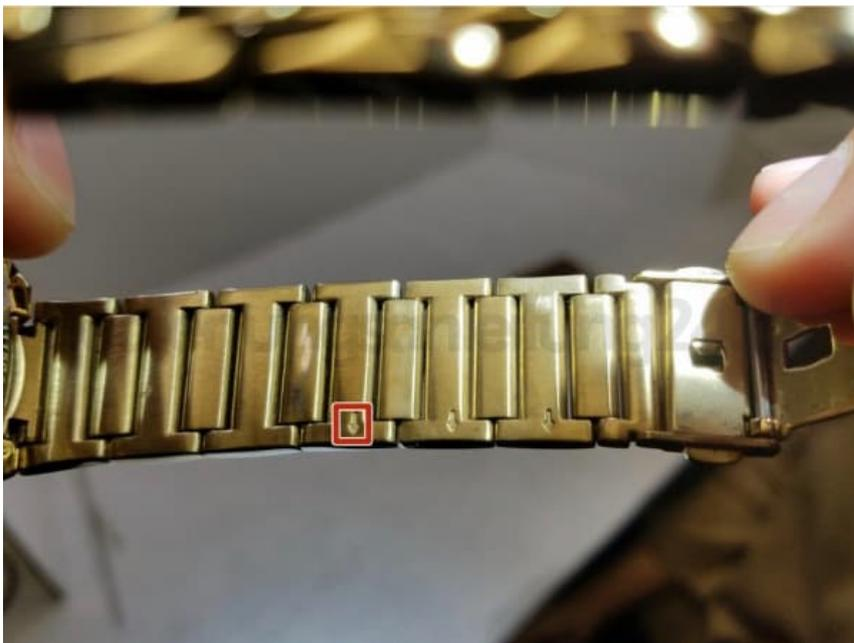
5. Wenn du beschädigte oder zusätzliche Glieder entfernst, halte ein Ende des Stiftschiebers gegen den zu entfernenden Stift.
