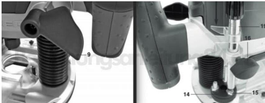
2. Maschine langsam nach unten bewegen, bis der Fräser das Werkstück berührt.
