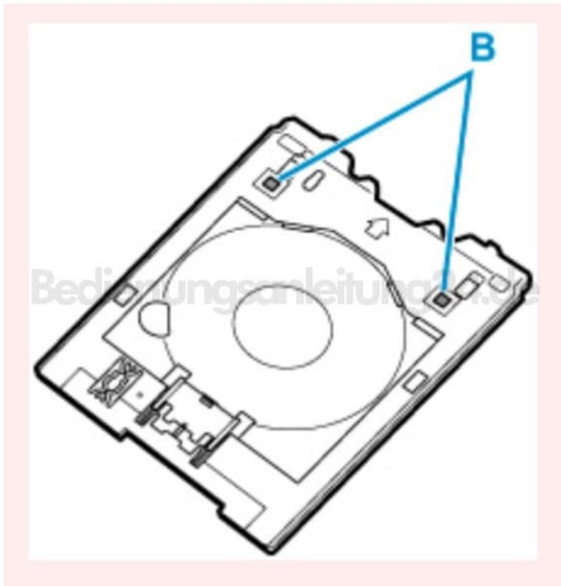
3. Legen Sie den bedruckbaren Datenträger MIT DER ZU BEDRUCKENDEN SEITE NACH OBEN ein und drücken Sie ihn unten gegen die Verriegelung (C).
