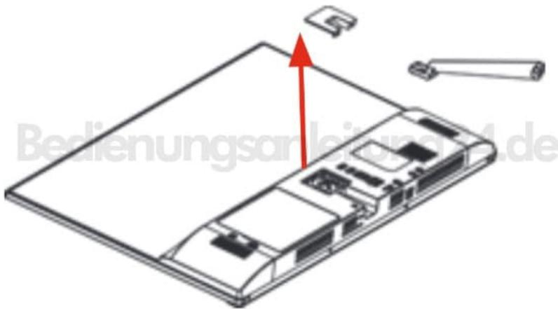
2. Montiere den Ständer mit den Schrauben am Gehäuse.
