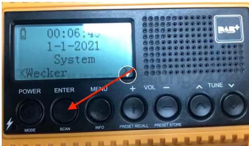
3. Drücke die Taste **ENTER** so lange, bis im Display unten angezeigt wird:
