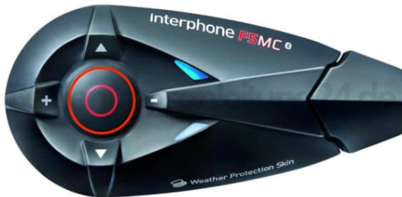
2. Aktiviere das SET UP-Menü, indem du im Standby-Modus (blaues LED-Licht blinkt) zuerst die **UP** Taste drückst.
