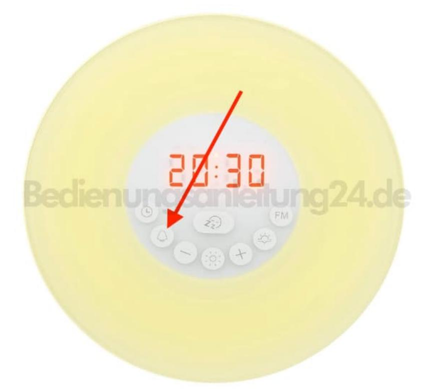
7. Ist der Alarm aktiviert, erscheint ein Glocken-Symbol über dem Doppelpunkt zwischen Stunden- und Minutenanzeige.
